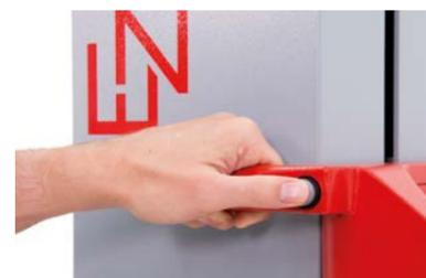
**Impugnatura di comando ad una mano EZset** per una semplice posizionamento della slitta di misurazione sul tagliente dell'utensile e per un azionamento ergonomico ed user-friendly.
