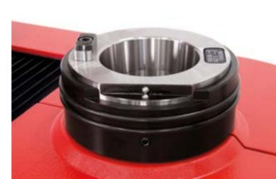
**Mandrino portautensili SK50** con elevata precisione di rotondità e spigolo di calibratura integrato.
