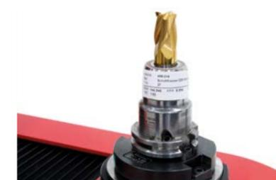
**Stampa etichette:** Ricevete in modo preciso, affidabile e nel giro di pochi secondi cinque risultati di misurazione, con lunghezza, diametro, raggio, nonché angolo 1 e 2 del tagliente dell'utensile.
