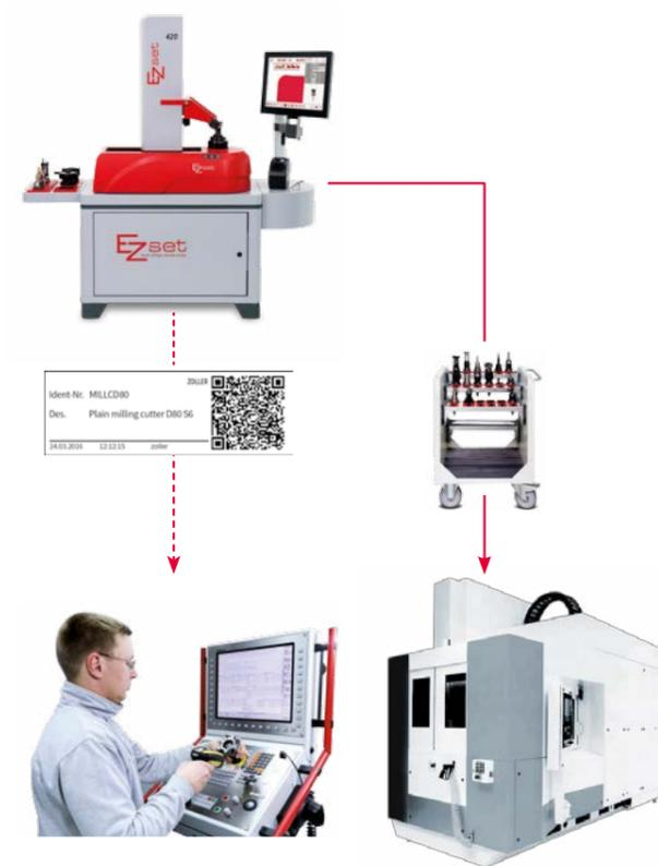
**1** Installare gli utensili sull'apparecchio di presettaggio utensili ed effettuare la misurazione.
