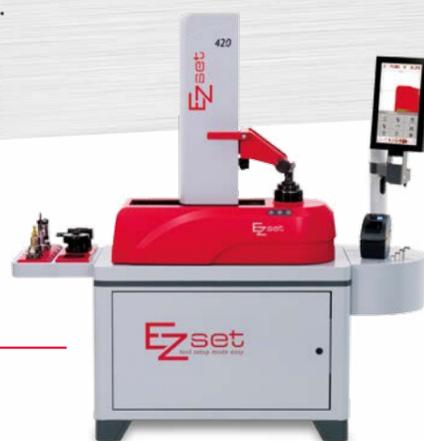
**1** Installare gli utensili nell'apparecchio di presettaggio utensili.
