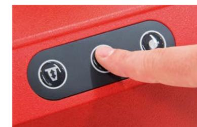
**Tastiera a membrana** per l'azionamento pneumatico dell'indicizzazione 4x90° e freno del mandrino portautensili SK50. In opzione il bloccaggio sottovuoto.
