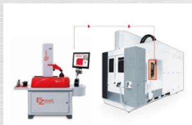
**Trasmissione dati con IC2 e IC3 direttamente alla macchina CNC**
