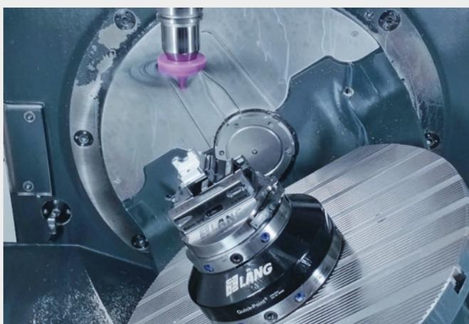
Clean·Tec è indispensabile per processi fluidi nella produzione automatizzata e non presidiata. Prima della rimozione automatica da parte del sistema di movimentazione o del robot, pulisce in modo affidabile il dispositivo di serraggio, il pezzo e la tavola della macchina.
