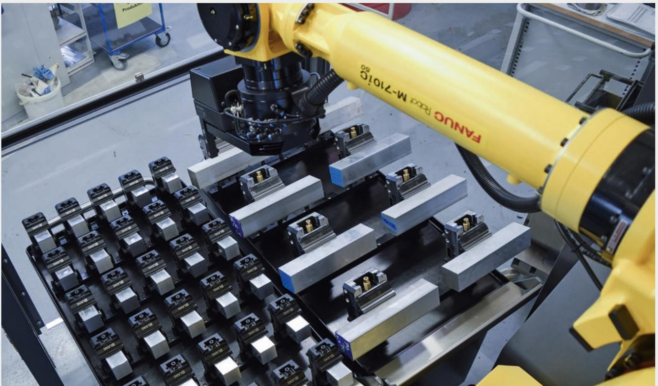
Con l'interfaccia di cambio pinza, RoboTrex 96 ottiene una nuova caratteristica standard che garantisce una varietà di pezzi e una flessibilità ancora maggiore grazie al prelievo del punto zero sul braccio del robot. L'interfaccia pneumatica rende possibile la commutazione tra due dimensioni di pinze. Questo permette di utilizzare tutti i componenti del più
